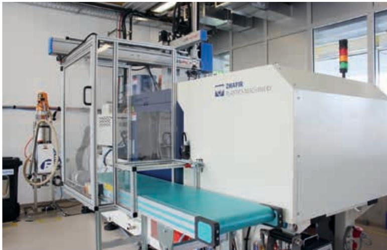
Mithilfe dieser Spritzgießmaschine der chinesischen Firma Zhafir werden Kunststoffe mit Platz für Magneteinfassungen hergestellt.
