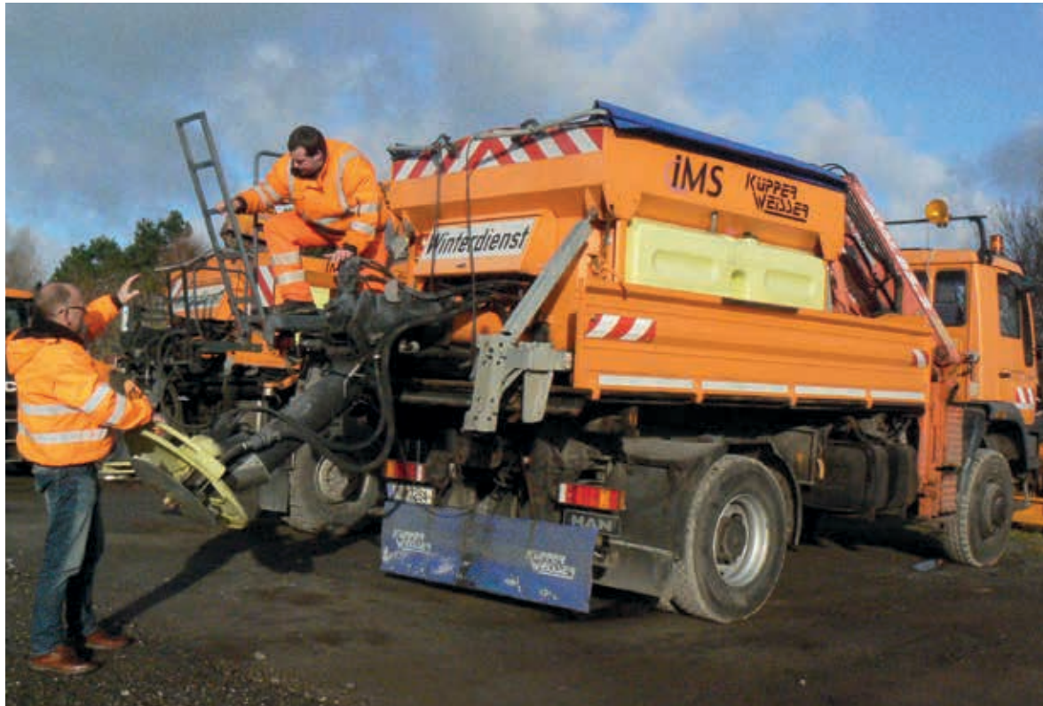
Der Leiter der Kreisstraßenmeisterei Marko Wulff (l.) und Straßenmeister Sebastian Beilfuß beim Checken für den Straßenwinterdienst. Ein 18 t LKW von MAN wird mit einem Feuchtsalzstreuer umgerüstet.
