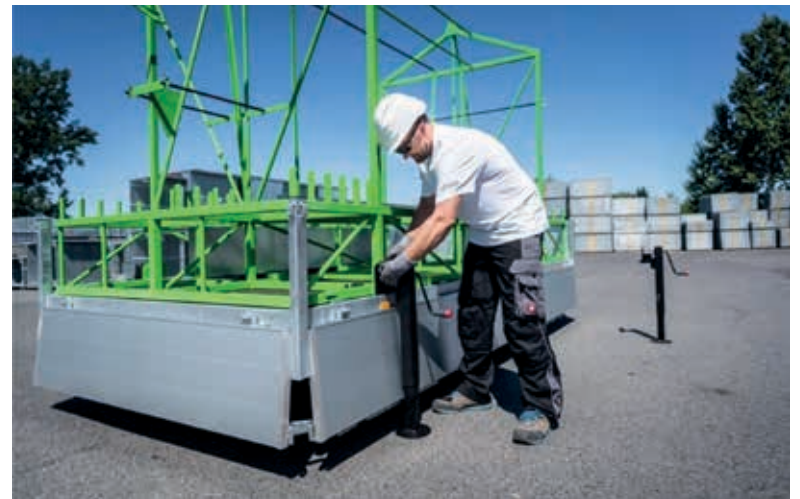
Die Füße für die Wechselbrücke sind schnell montiert. Zwei Flügelmuttern und zusätzliche Bolzen geben sicheren Halt.
