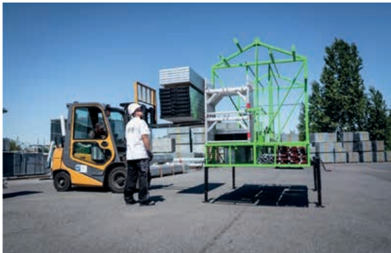
Die einzelnen Böden können von Hand oder mit dem Gabelstapler verladen werden. Holz, Alu, Stahl – alle Arten von Belägen sind möglich.
